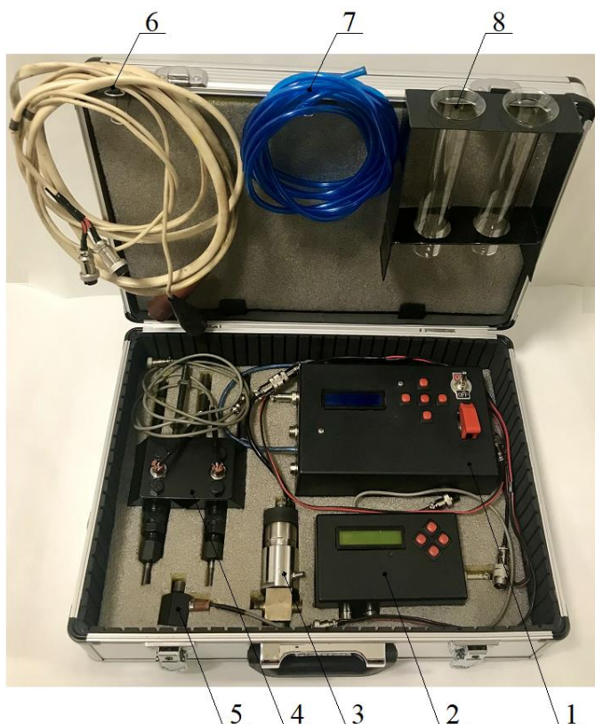
Рисунок 17 Комплект устройств для диагностирования и регулирования ТА непосредственного действия: 1 и 2 – электронные блоки УПВ и КПВ; 3 – УПВ; 4 – КПВ; 5 – штуцер с датчиком давления; 6 – провода питания; 7 – топливопроводы низкого давления; 8 – накопительные емкости (мензурки)
