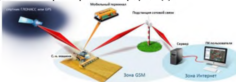
Рис. 1. Схема работы информационно-навигационной системы [2]
