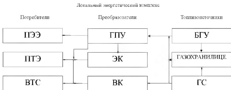
Рис.1. Локальный энергетический комплекс с направлениями энергетических потоков
