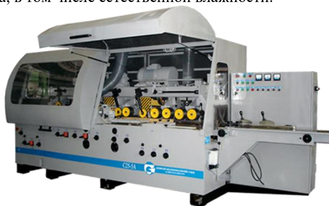
Рис. 1. Станок строгальный четырёхсторонний, модель С23-5А
