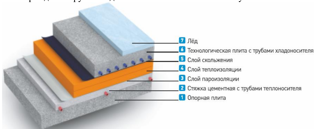
Рис.1. Конструкция основания с бетонной плитой
