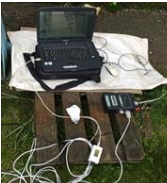
Рис. 2. Поточный влагомер зерна «Фауна-ПМДР 4»
