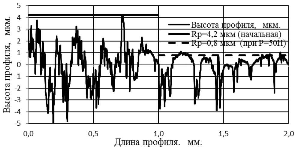
Рис. 4. Профиль поверхности вала после шлифования и после выглаживания в среде геомодификатора трения силой давления индентора 50 Н
