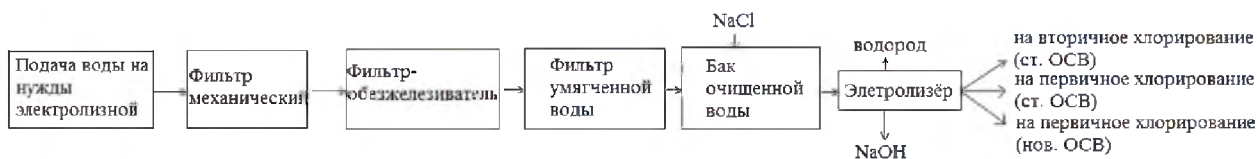
Рис. 1. Схема водоснабжения города
