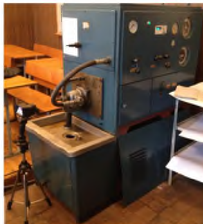
Рис. 2. Стенд КИ 4815м – экспериментальная установка с применением тепловизора Testo 881
