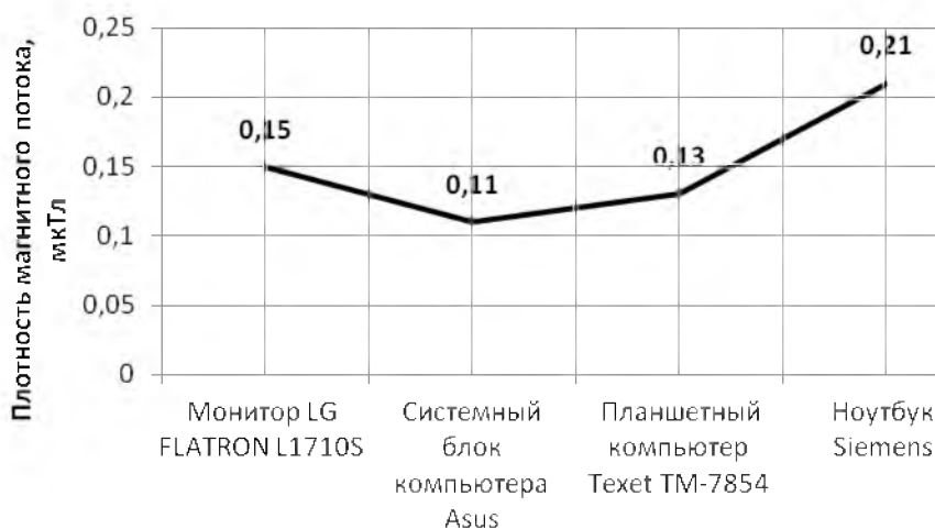
Рис. 1. Средние значения результатов измерений плотности магнитного потока от компьютерной техники
