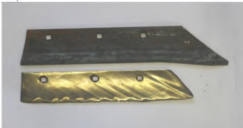
Рис.1. Рабочая поверхность лемеха РЗЗ ПЛЖ 31702 до и после испытаний
