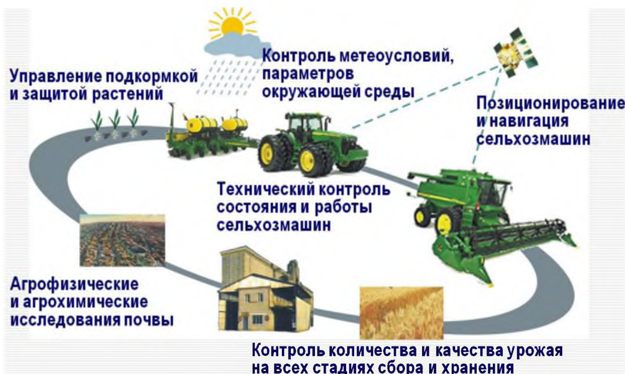
Рис. 1. Схема реализации системы точного земледелия
