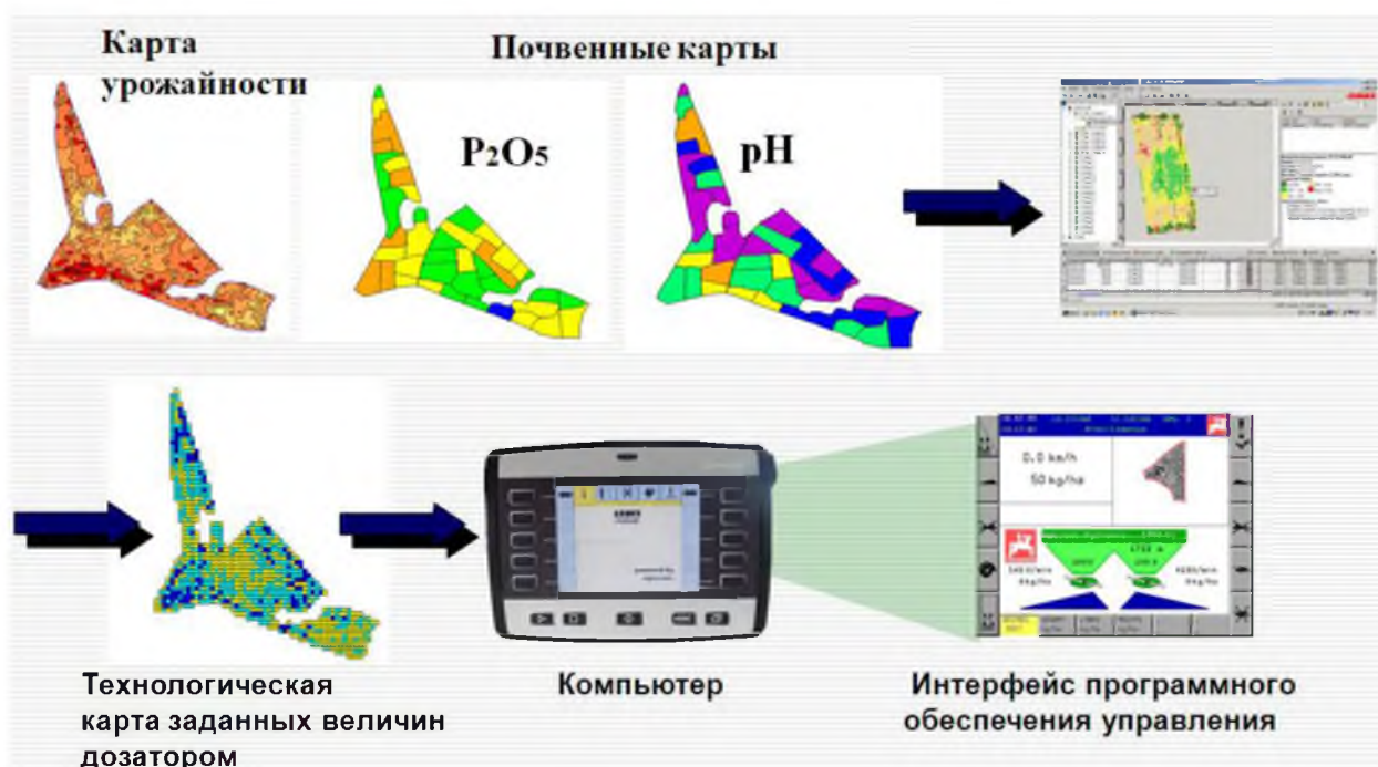
Рис. 2. Схема управления дозаторами разбрасывателя минеральных удобрений бортовым компьютером
