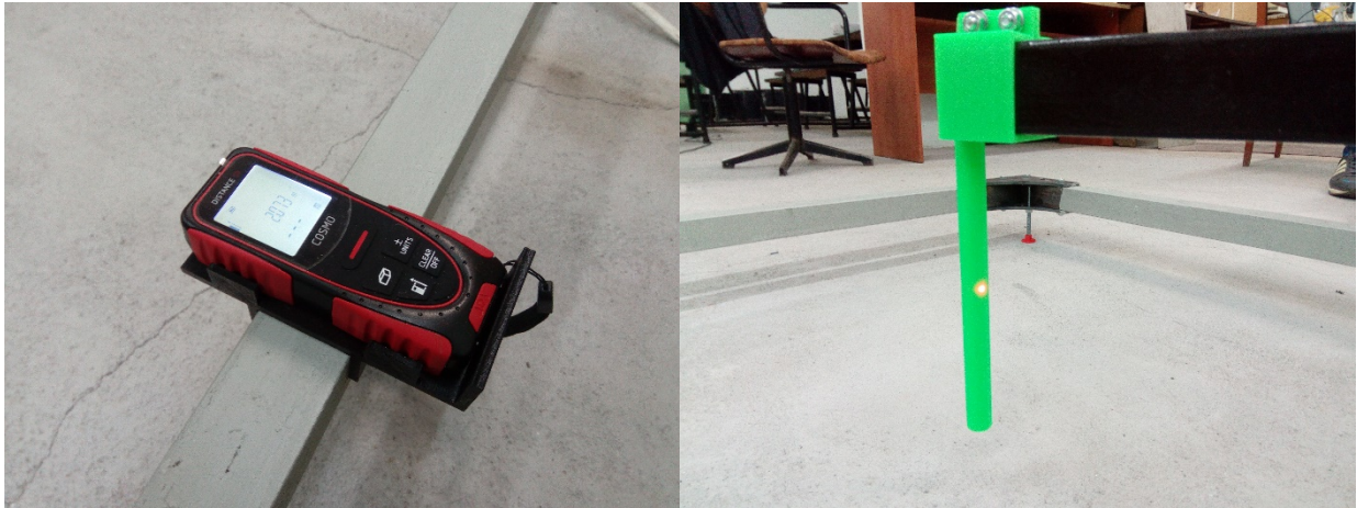
Рис. 2. Устройство для измерения координат и флажок для обозначения точки перемещения манипулятора
