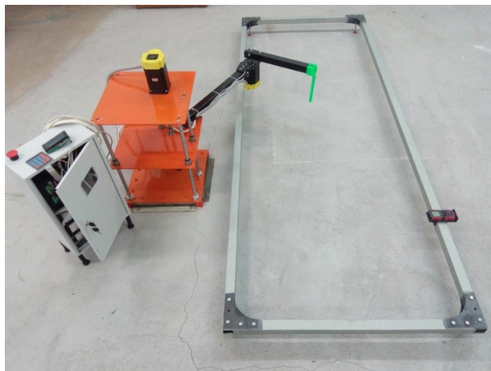
Рис. 1. Лабораторная установка для изучения факторов, влияющих на точность позиционирования рабочего органа в пространстве
