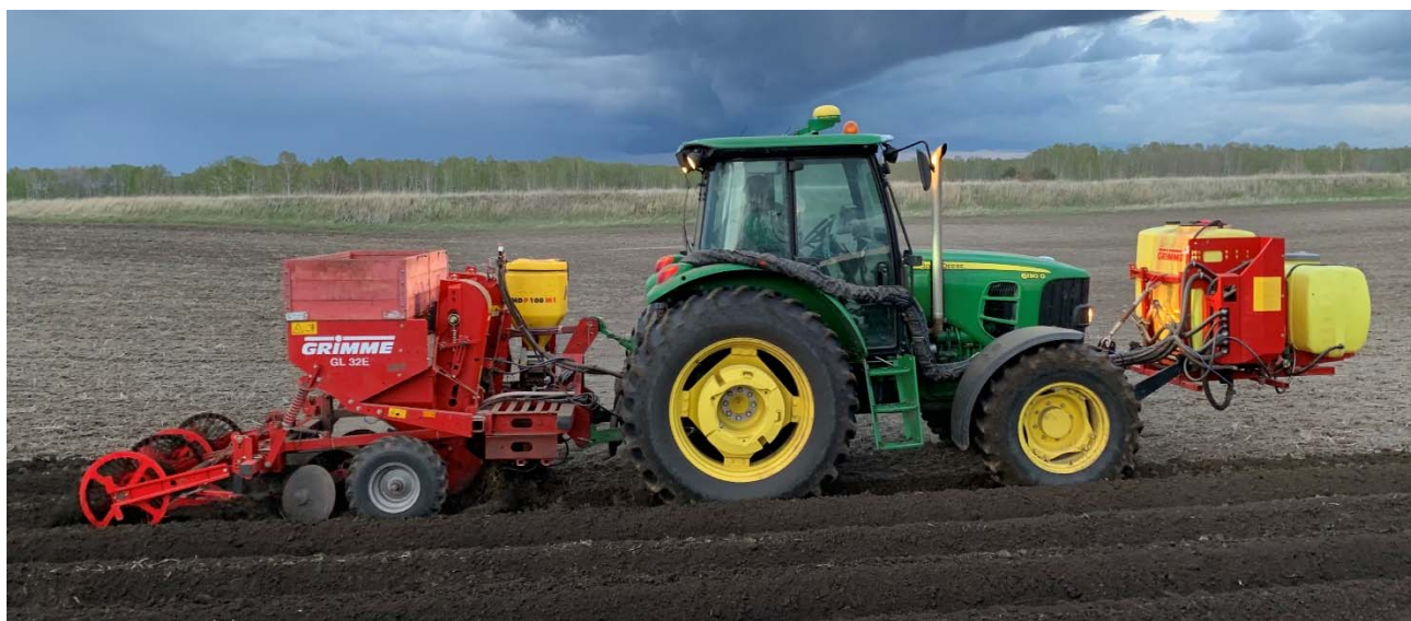
Рис. 7. Макетный образец картофелепосадочного технологического комплекса на базе посадочной машины GL 32E
