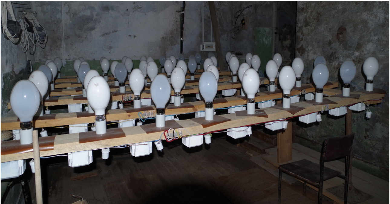
Рис. 3. Пакет ламп из 54 шт. типа VIALOX NAV-E (нагрузка экспериментальной установки)
