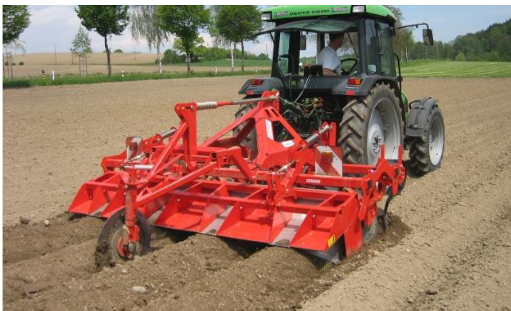
Рис. 2. Пропашной культиватор-гребнеобразователь GN-4
