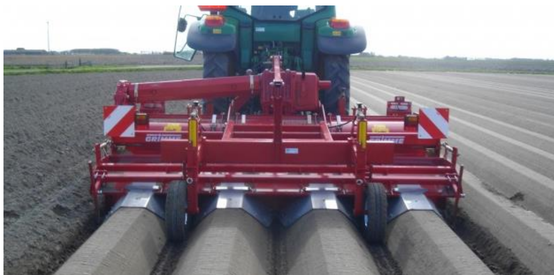
Рис. 1. Фрезерный культиватор-гребнеобразователь GF-400
