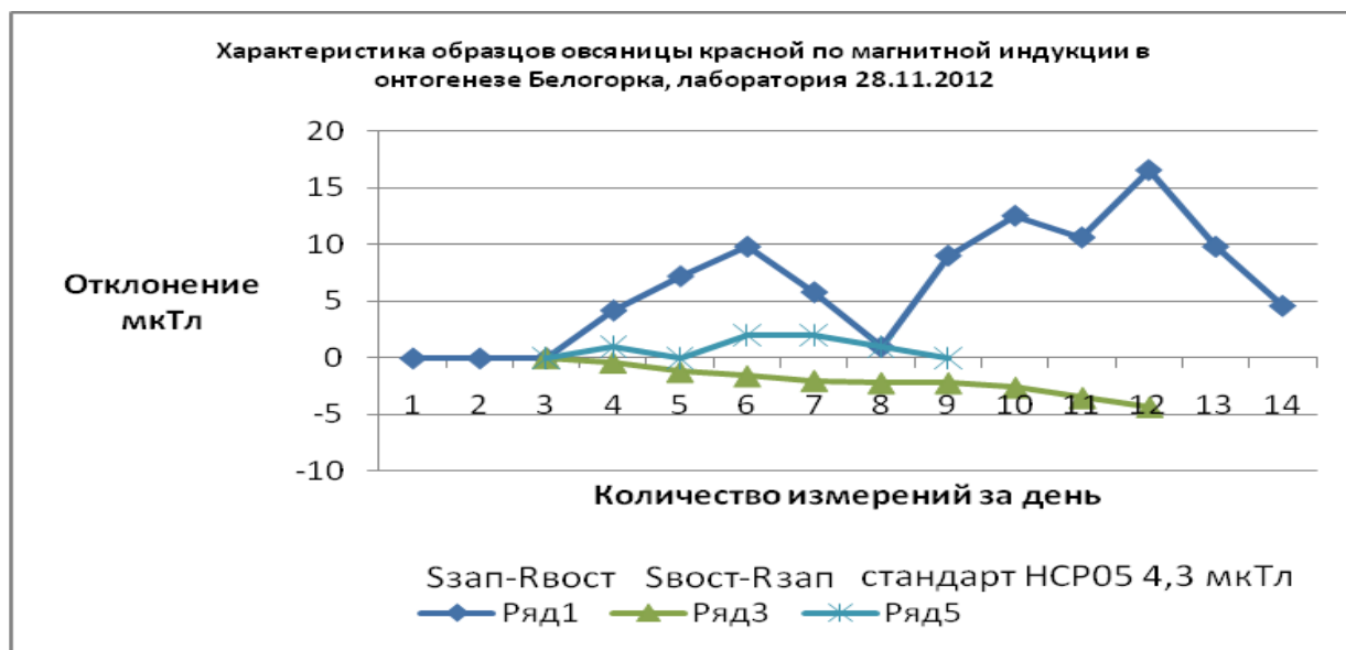
Рис. 2. Отклонение по величине магнитной индукции переменного магнитного поля здоровых и пораженных сколекотрихозом растений овсяницы красной ( сорт Северная 32)
