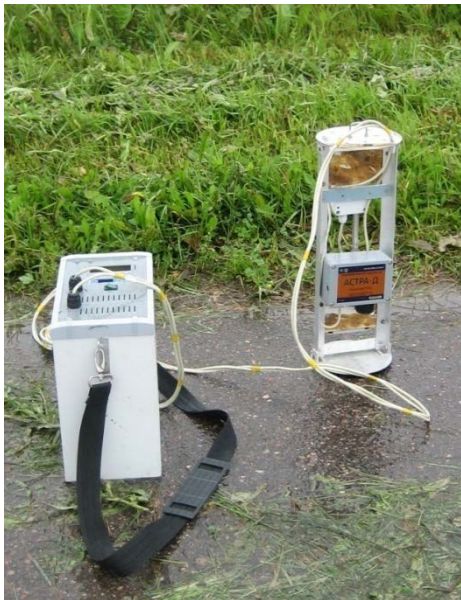
Рис. 3. Мобильная установка для измерения параметров микроклимата
