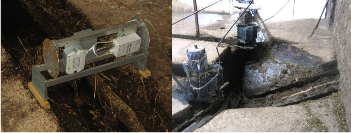
Рис. 2. Процесс замеров параметров микроклимата над навозным каналом и накопительной емкостью
