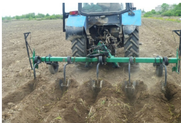
Рис. 2. Нарезка гребней и междурядная обработка с глубоким рыхлением экспериментальным культиватором окучником-глубокорыхлителем КОР-2,8 (конструкция ИАЭП – ФИЛИАЛ ФГБНУ ФНАЦ ВИМ, предлагаемая технология)
