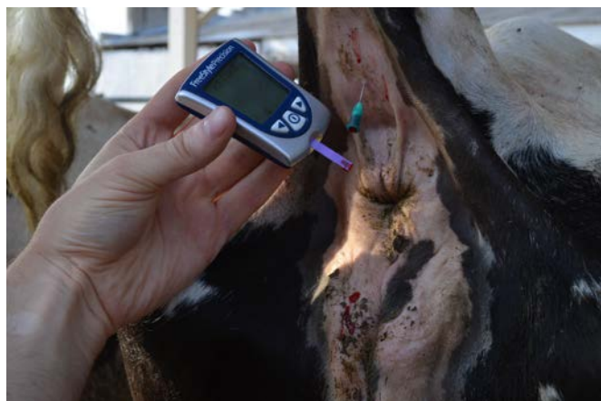
Рис. 2. Устройство «Precision Xtra Meter» для анализа содержания глюкозы и ВНВА в крови
