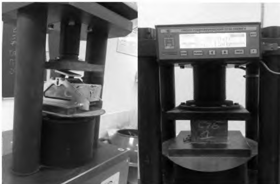
Рис.1. Испытание бетонных образцов
