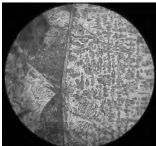
сталь 20, переходная зона ( \times 500 )
