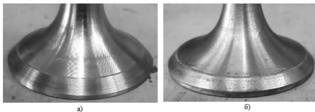
Рисунок 2. Клапана до испытаний: а) стандартный клапан; б) модифицированный клапан Figure 2. Valves before testing a) standard valve; b) modified valve
