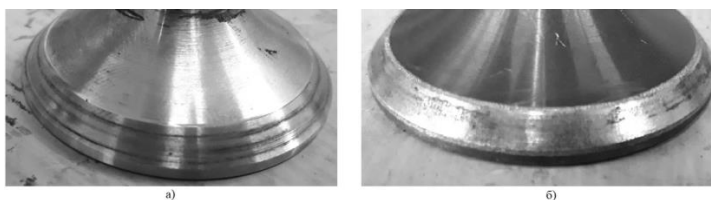
Рисунок 3. Клапана после испытаний: а) стандартный клапан; б) модифицированный клапан Figure 3. Valve after testing: a) standard valve; b) modified valve
