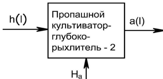
Рис. 1. Информационная модель технологического процесса разуплотнения почвы при функционировании пропашного культиватора-глубокорыхлителя
