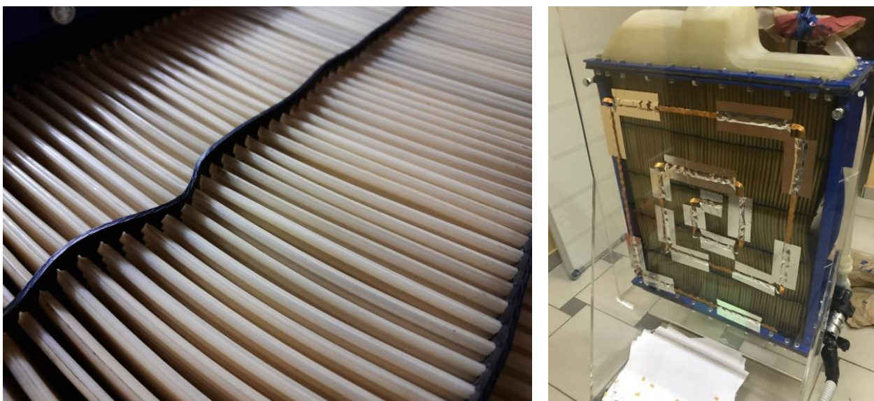
Рис. 3. Полимерные пластины жидкостного радиатора трактора МТЗ-82 [9]
