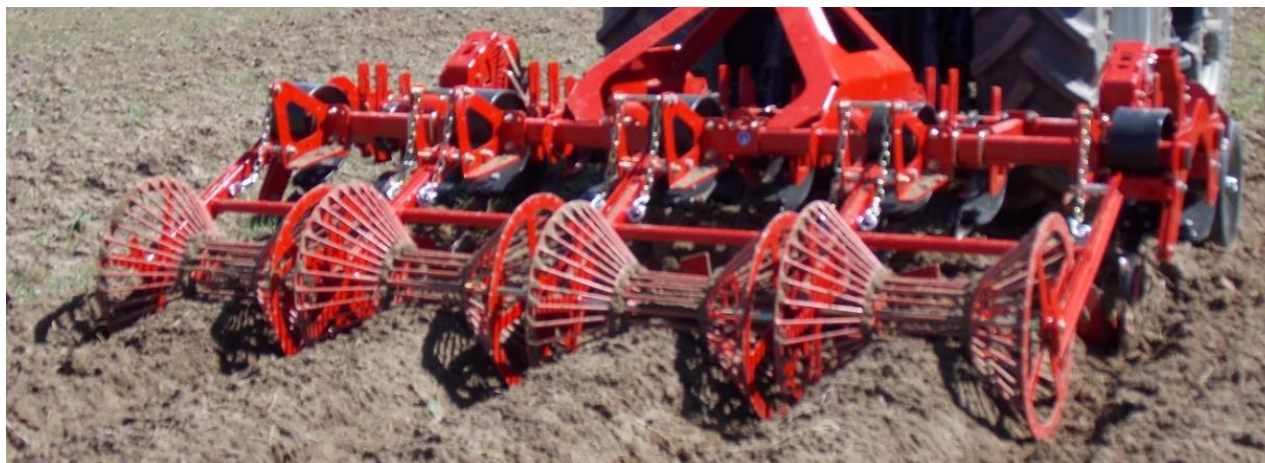
Рис. 1. Пропашной культиватор-глубокорыхлитель с рыхлительными лапами и прутковыми катками-гребнеобразователями
