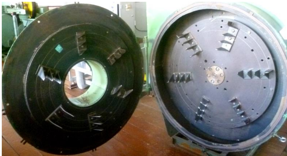
Рисунок 2. Вид ротора (справа) и статора (слева) исследуемого дезинтегратора Figure 2. View of the rotor (right) and stator (left) of the investigated disintegrator
