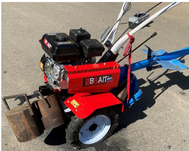
Рис. 2. Расположение балластных грузов на передней части мотоблока 225P19 Brait
