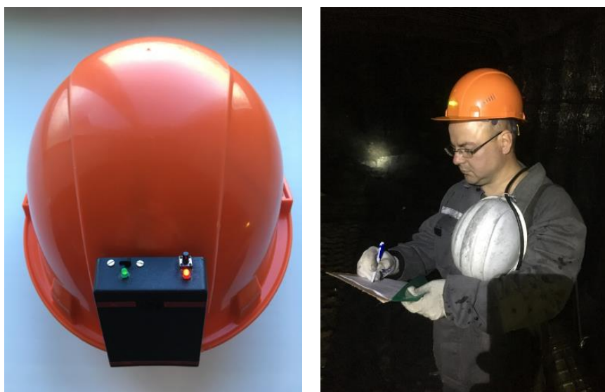
Рис. 2. Защитная каска с индивидуальной автоматизированной системой мониторинга
