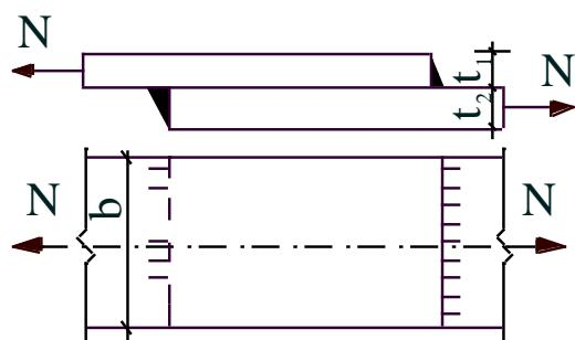
**Задача 4.** Проверитьстыковой сварной шов на действие расчетного усилия  $N=48$ кН и расчетного момента  $M=12$ кНм. Общие характеристики: марка стали деталей С255 по ГОСТ 27772; коэффициент условия работы для элементов соединения равен 1,0; вид сварки: ручная; марка электрода Э46 по ГОСТ 9467; положение шва: нижнее; толщины стыкуемых деталей  $t_1=12$ мм,  $t_2=10$ мм; ширина деталей  $b=300$ мм; сварные швы не выводятся на стальные подкладки.
