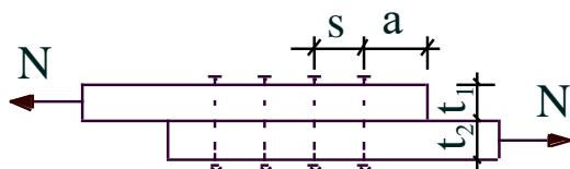
**Задача 3.** Проверить лобовые угловые сварные швы на прочность. Общие характеристики: расчетное усилие  $N=66$ кН; марка электрода Э46 по ГОСТ 9467; коэффициент условия работы для элементов соединения равен 1,0; марка стали соединяемых деталей С255 по ГОСТ 27772; вид сварки: ручная; положение шва: нижнее; катет шва 6,0 мм; толщины деталей  $t_1=10$ мм,  $t_2=8$ мм; ширина деталей  $b=220$ мм; сварные швы не выводятся на кромки деталей.
