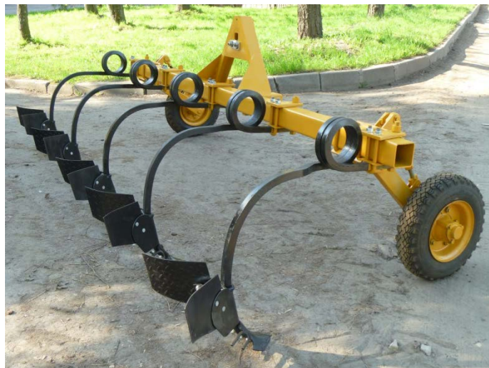
Рис. 1. Культиватор-окачник глубокорыхлитель на упругой стойке конструкции ИАЭП – ФИЛИАЛ ФГБНУ ФНАЦ ВИМ
