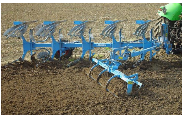
Рис. 2. Интегрированный почвоуплотнитель LEMKEN FixPack [4, 5]
