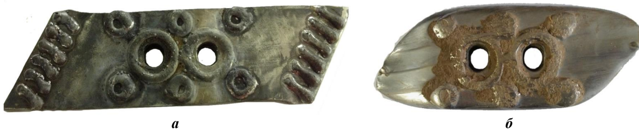
Рис. 2. Долото, упрочненное твердым сплавом кольцевыми и прямолинейными валиками: а – долото, упрочненное наплавкой; б – долото после износа в условиях экстремальной атаки
