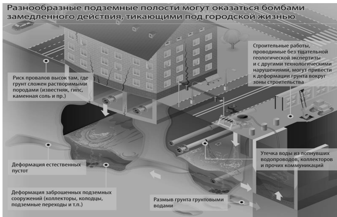
Рис. 2. Причины провалов грунта
