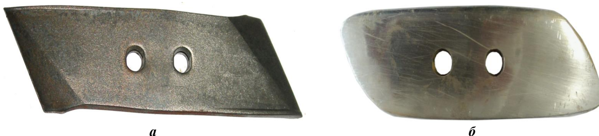
Рис. 1. Долото лемеха фирмы Kverneland: a – новое долото; б – долото после износа
