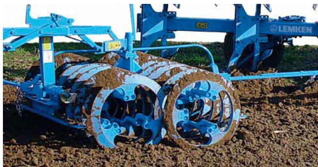
Рис. 5. Двойной уплотнитель LEMKEN VarioPack (два ряда колец)
