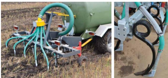
Рис. 2. Бочка с культиватором для внесения жидких органических удобрений (завод «Кобзаренка», г. Самара)
