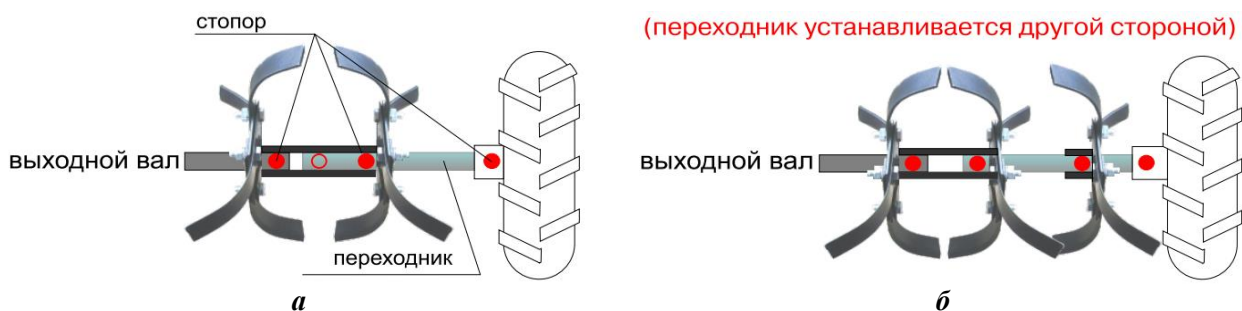
Рис. 4. Схемы увеличения ширины захвата фрезбарабанов мотоблоков [8]: а – установка колес с 4 фрезами; б – установка колес с 6 фрезами
