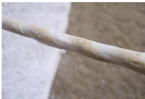
Рис. 2. Стекловолокно на основе аминного отвердителя
