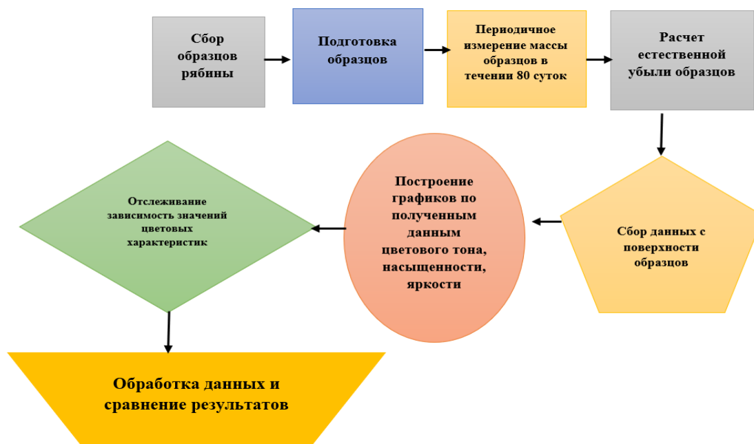
Рис. Схема проведения эксперимента по определению корреляционной зависимости между цветовыми характеристиками и естественной убылью массы растительной продукции
