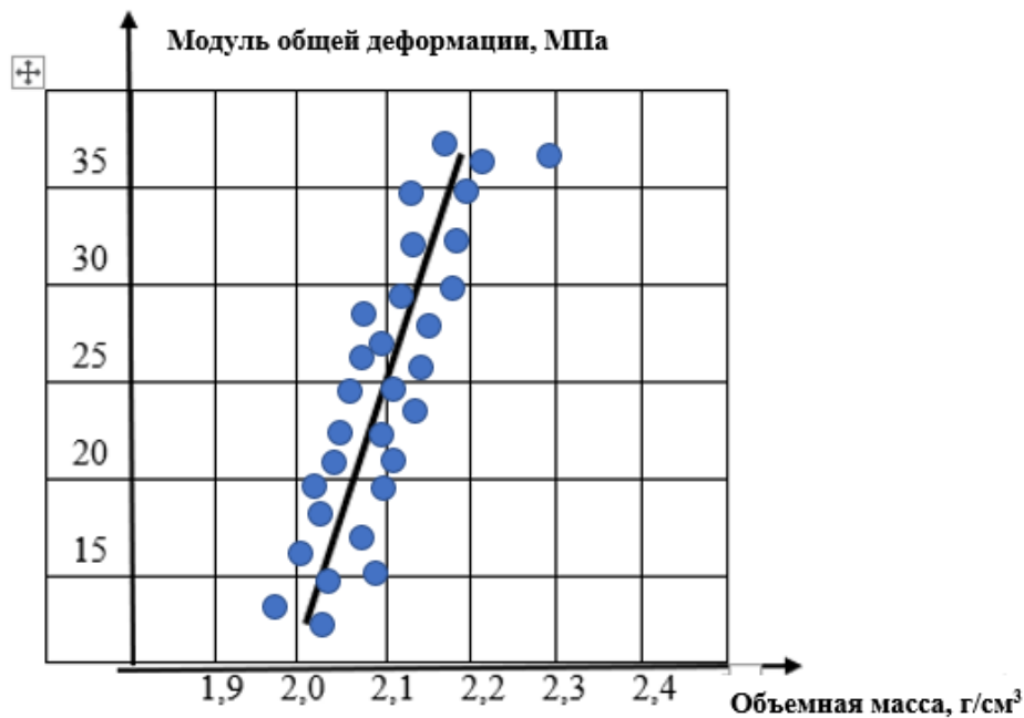
Рис. 2. Изменение модуля общей деформации Лужской морены в зависимости от плотности ее сложения (Санкт-Петербург)
