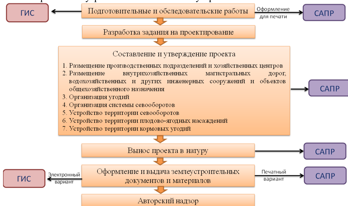
Рис. Схема применения ГИС и САПР при составлении проектов внутрихозяйственного землеустройства
