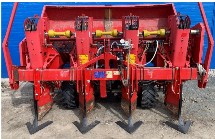
Рис. 1. Комплектация картофелепосадочной машины стрелчатыми лапами для полосового способа обработки почвы
