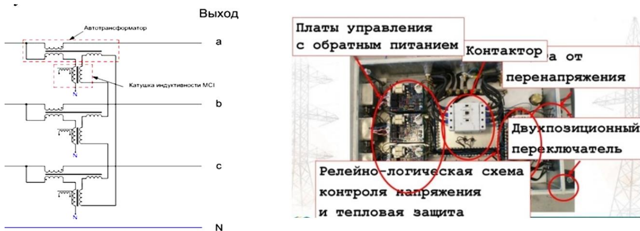
Рис. 2. Устройство ВДТ
