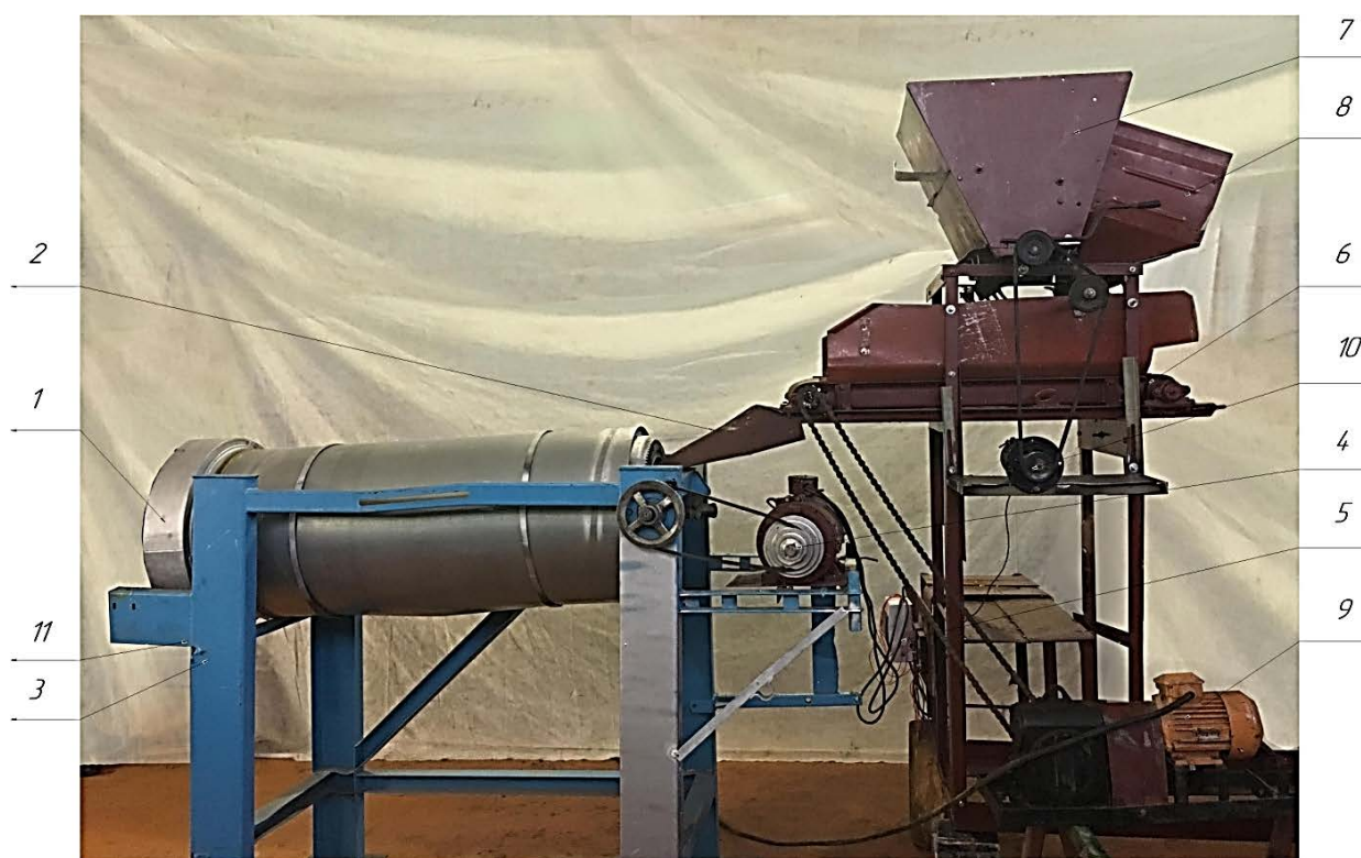
Рис. 1. Установка для исследования работы барабанно-лопастного смесителя: 1 – барабан; 2 – загрузная воронка; 3 – рама; 4 – электродвигатель привода барабана смесителя; 5 – регулятор оборотов электродвигателя; 6 – транспортер; 7 – дозатор минеральных удобрений; 8 – дозатор сапропеля; 9 – электродвигатель привода транспортера; 10 – электродвигатель привода дозаторов; 11 – выгрузная воронка
