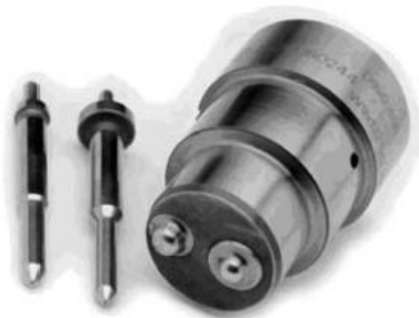
Рис. 2. Комбинированная форсунка с двойным сопловым наконечником фирмы Wärtsilä
