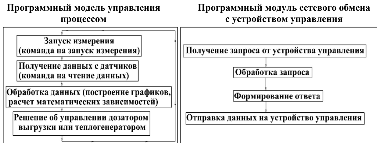
Рис. 2. Алгоритм работы устройства контроля окончания сушки
