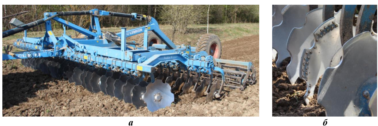
Рис. 2. Полевые исследования (АО «ПЗ «Краногвардейский», 2019 г.): а – почвообрабатывающий агрегат – LEMKEN Rubin 9/600 КУА; б – исследуемый рабочий орган на дисковой батарее
