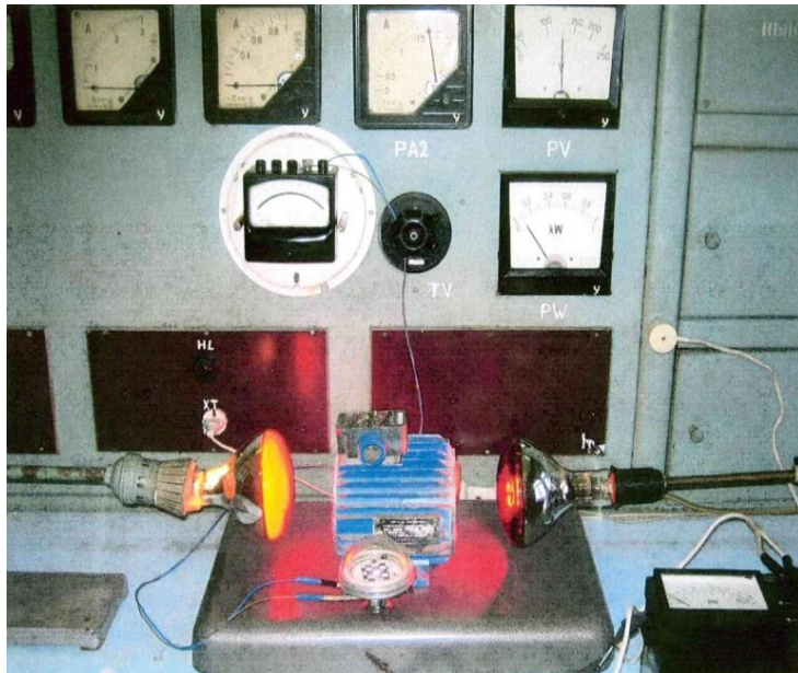
Рис. 3. Сушка статора асинхронного двигателя лампами ИКЗК-220-250
