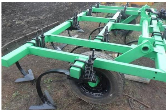
Рис. 1. Культиватор КПЭ-3,8 со стрелчатыми лапами для предпосевной подготовки почвы
