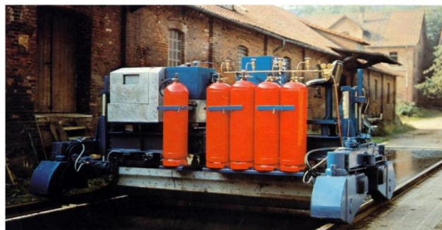
Рис. 4. Укладка литой асфальтобетонной смеси (I тип) с помощью финишёра AE-GDF
