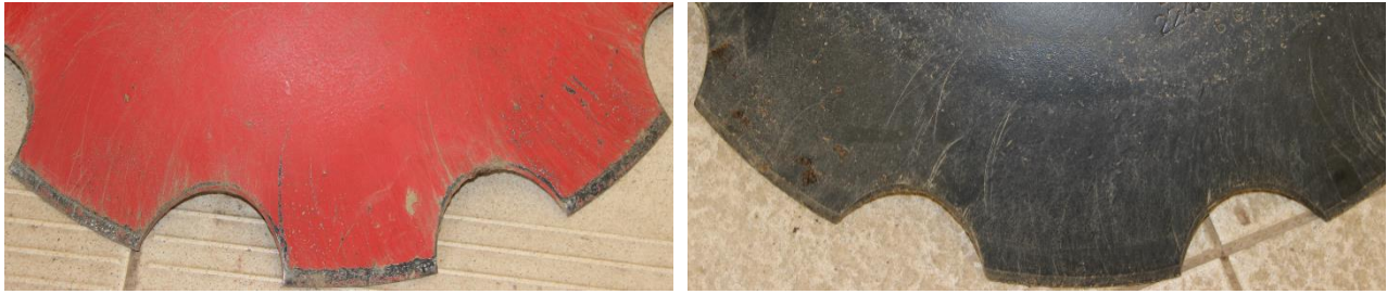
Рис. 2. Характерные направления абразивного износа на дисковых рабочих органах
