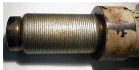
Рис. 2. Внешнее формирование износостойкого покрытия порошкообразным присадочным материалом при его подаче в столб сжатой дуги под действием сил тяжести частиц
