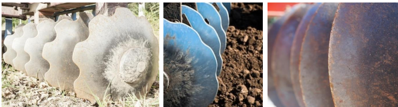
Рис. 1. Дисковые рабочие органы почвообрабатывающих машин, подвергнувшиеся износу
