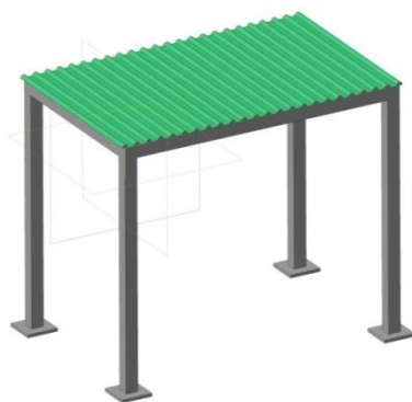
Рис. Разрабатываемая сварная площадка
