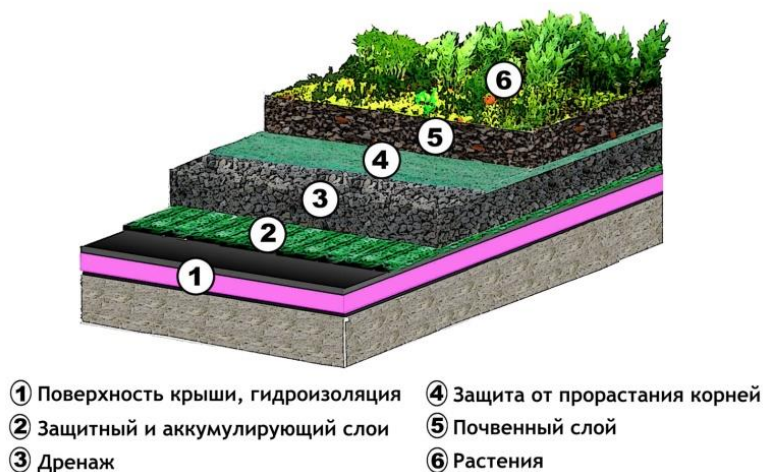
Рис. 2. Состав кровли «зеленой» крыши
