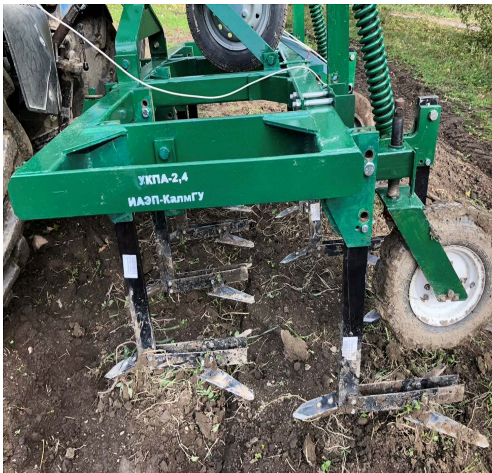
Рис. 1. Почвообрабатывающий агрегат МТЗ-82+УКПА-2,4 ИАЭП-КалмГУ с динамичными рабочими органами
