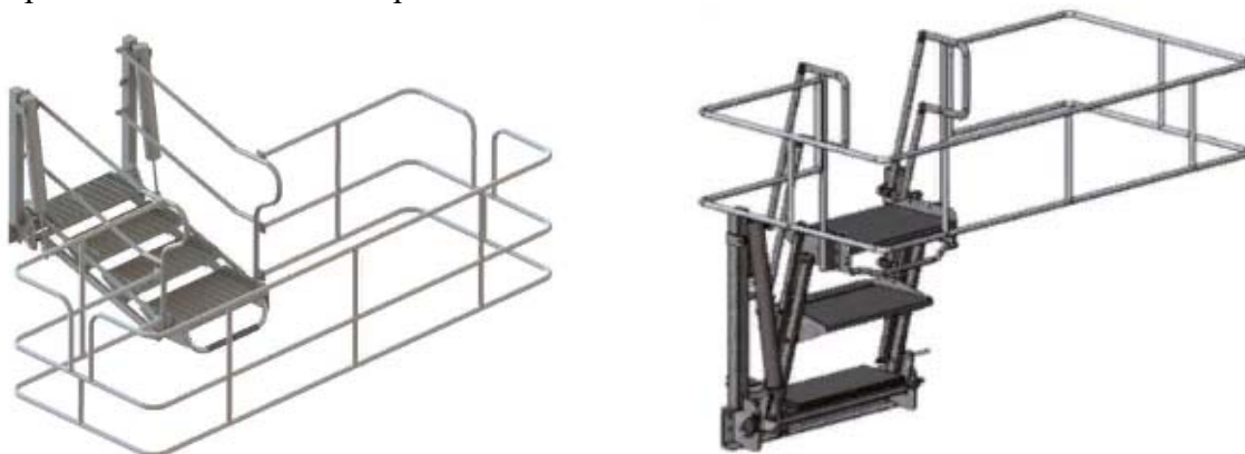
Рис. 2. Раздвижной мостик со стационарным ограждением в разобранном и собранном положении [7]
