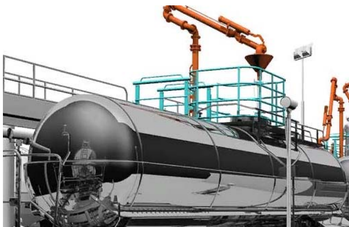
Рис.1. Стационарное ограждение на эстакаде
