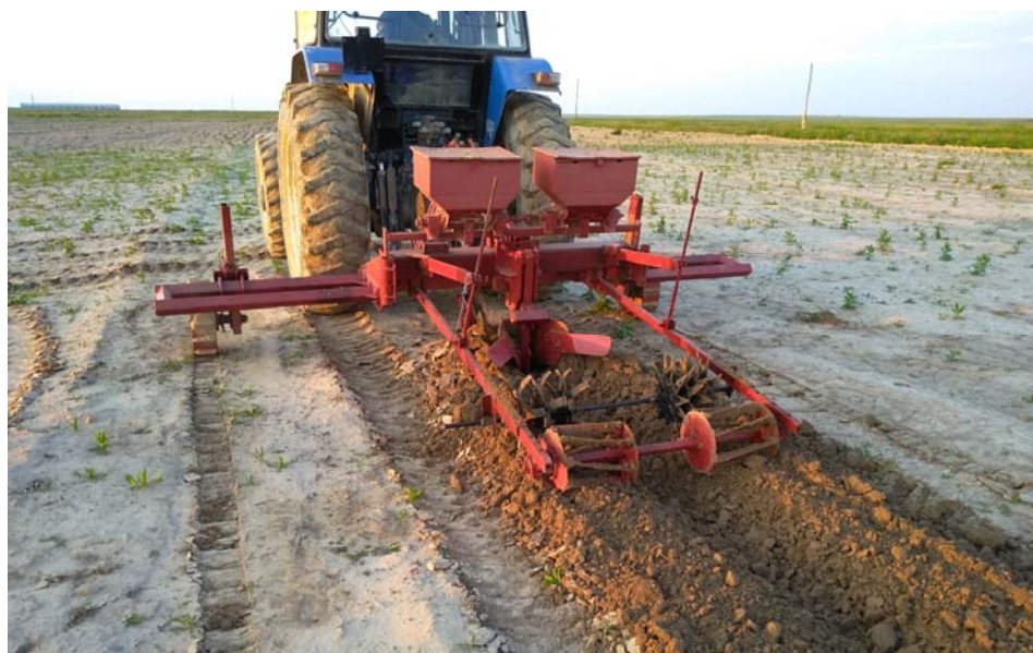
Рис. 4. Опытный образец комбинированного почвообрабатывающего агрегата в работе
