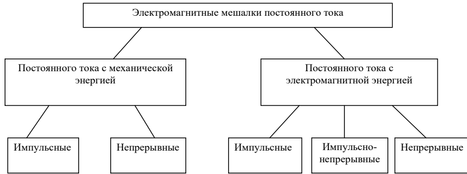
Рис. 3. Классификация мешалок по способу формирования сдвигового смещения слоев перерабатываемого материала
