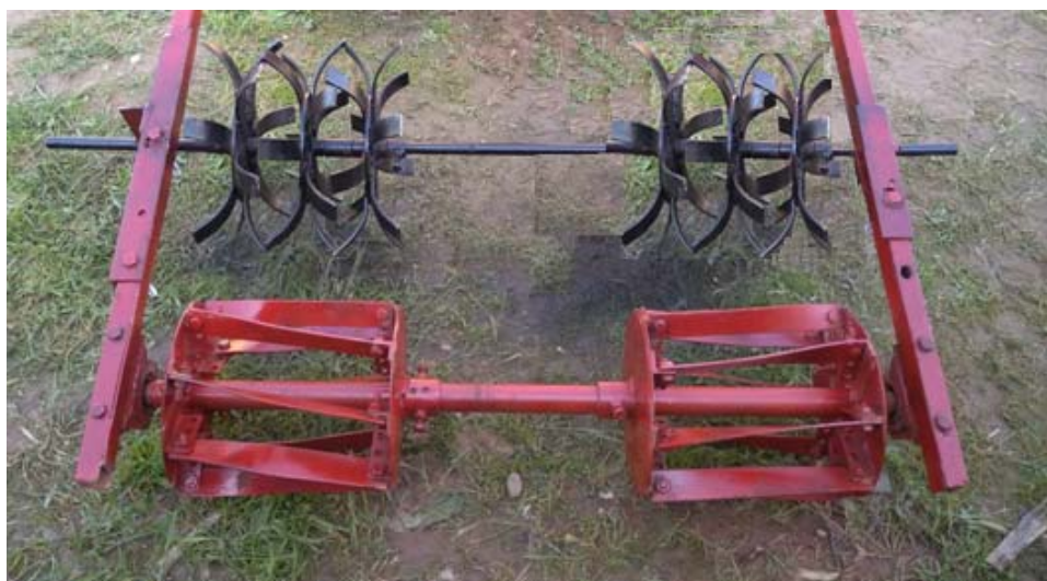
Рис. 3. Рыхлительно-выравнивающее устройство для полосовой предпосевной обработки почвы в зоне посева бахчевых культур
