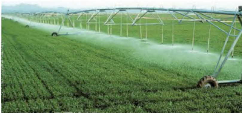
Рис. Дождевальная машина при поливе
