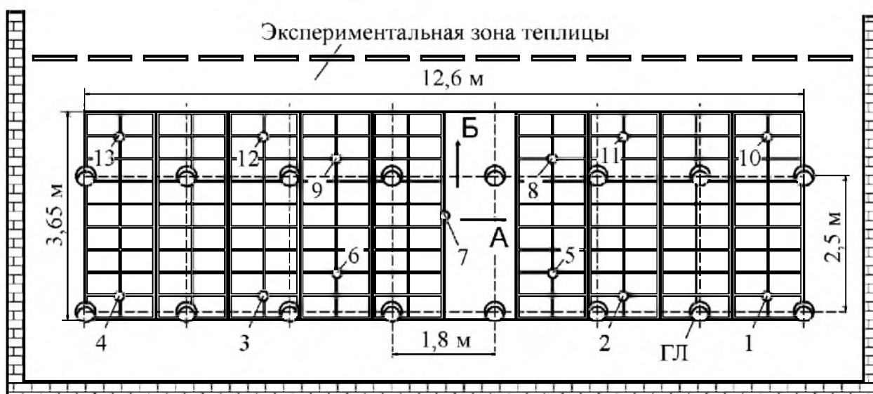
Рис. 1. Схема размещения контрольных точек и ламп над столами для выращивания рассады салата
