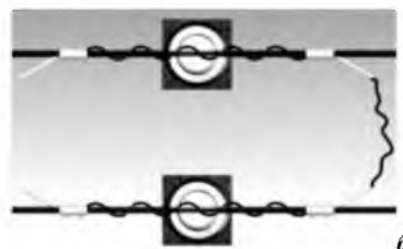
Рис. 4. Финская система защиты проводов от пережога с помощью дугозащитных рогов [2];
