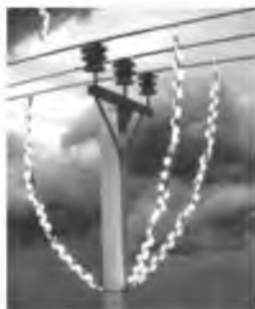
Рис. 7. Испытания на макете модульного разрядника РДИМ-10 [3]
