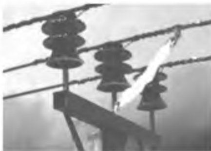
Рис. 8. Испытания компактного модульного разрядника РДИМ-10-К [3]
