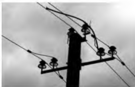
Рис. 6. Испытания шлейфового разрядника РДИПШ-10 на макете [3]
