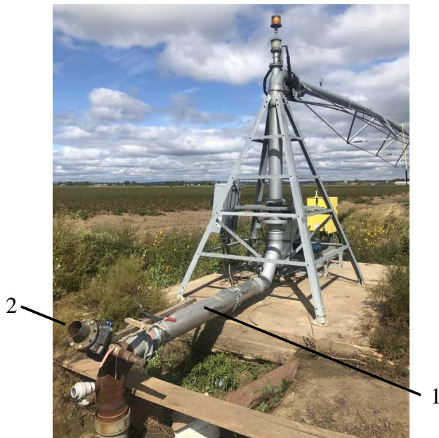
Рисунок 1. Центральная башня дождевальной машины фирмы T-L Irrigation company: 1 – напорный трубопровод; 2 – фланец присоединения дополнительного трубопровода Figure 1. The central tower of the sprinkler machine of the T-L Irrigation company: 1– pressure pipeline; 2 – flange connection of the additional pipeline
