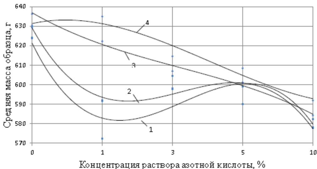
Рис. 5. Изменение прочности при изгибе образцов мелкозернистого бетона после выдержки в течение 28 суток в растворе азотной кислоты:
