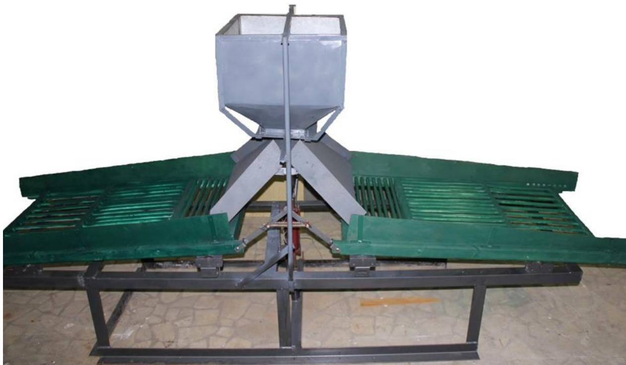
Рис. 2. Экспериментальная самоуравновешенная картофелесортировальная установка с линейным асинхронным электроприводом
