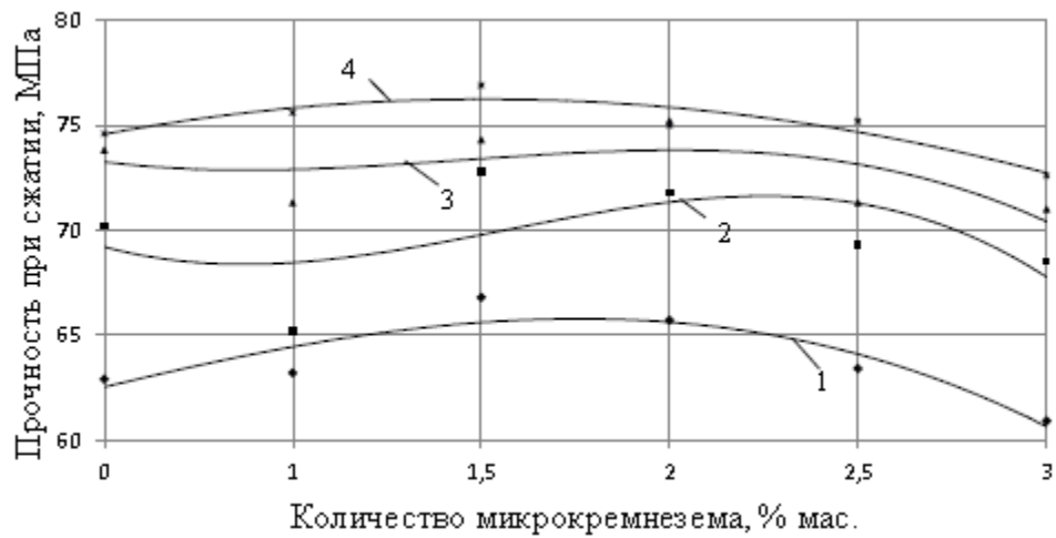
Рис. 1. Зависимость прочности цементного камня от количества добавки микрокремнезема: 1 – цементный камень в возрасте 3 суток; 2 – цементный камень в возрасте 7 суток; 3 – цементный камень в возрасте 14 суток; 4 – цементный камень в возрасте 28 суток
