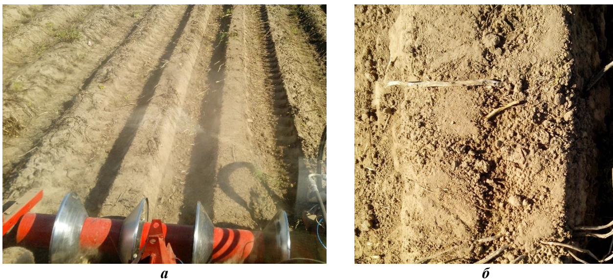
Рис. 3. Управляемый активный каток в составе ботвоуборочного агрегата: а – рабочий процесс при заделке трещин; б – вид поверхности гребня после прохода активного катка
