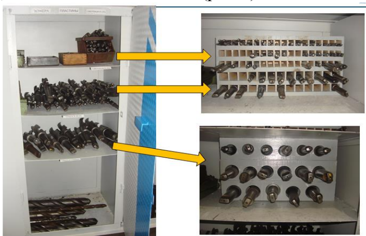
Рис. 2. Практическое применение шага 2: «Рациональное расположение предметов» Метода 5S на примере сборочно-сварочного участка машиностроительного завода Санкт-Петербурга
