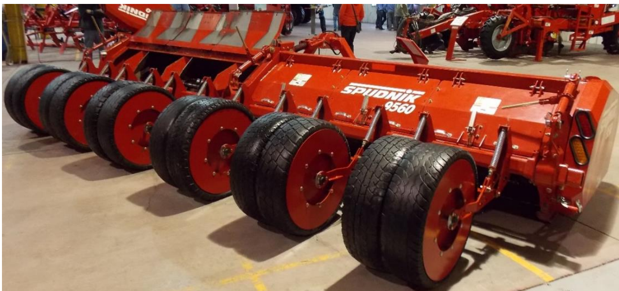
Рис. 2. Роторный ботводробитель с дополнительным орудием в виде широкопрофильных прикатывающих колес низкого давления
