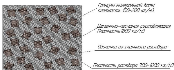
Рис.1. Структура раствора с гранулами из минеральной ваты
