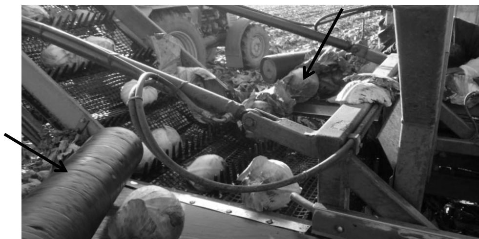
Рис.2. Выгрузной элеватор машины «AZA-LIFT»: → листоотделители (гладкие)
