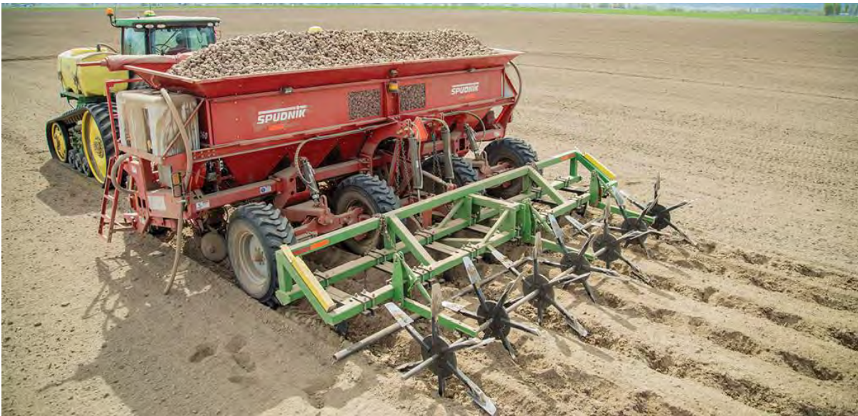
Рис. 3. Пропашной культиватор-глубокорыхлитель, навешенный на 3-х точечную навеску картофелепосадочной машины и оснащенный лункователем
