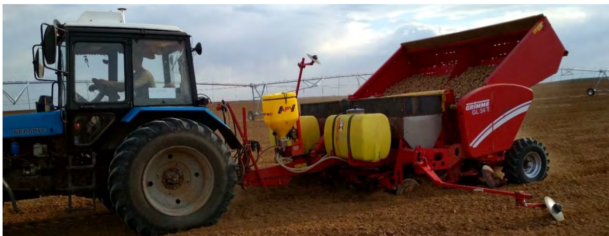
Рис. 2. Техническая система для внесения влагоудерживающих препаратов с подачей гранул воздушным потоком PS 300 M1, установленная на картофелесажалку Grimme GL 34 T
