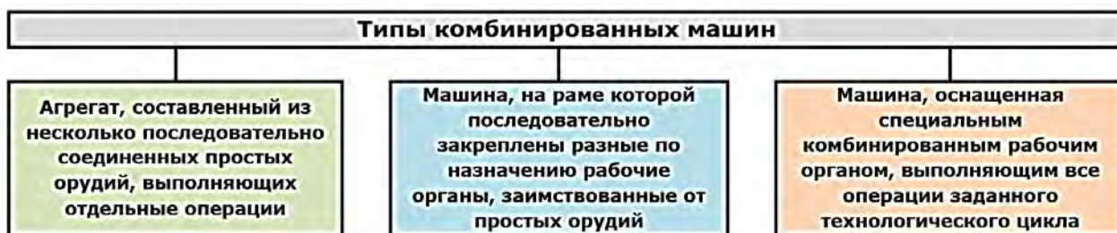
Рис. 1. Основные типы комбинированных машин [по [2]]
