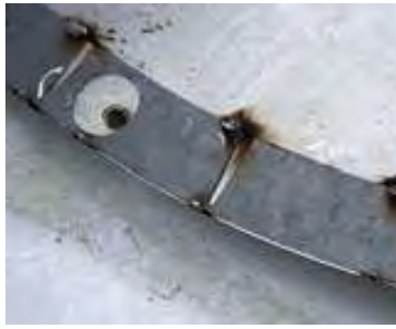
Рис. 2. Прихватывание накладки к шнеку
