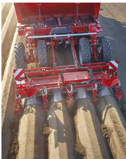
Рис. 1. Система прерывистого бороздообразования, установленная на комбинированном картофелепосадочном агрегате
