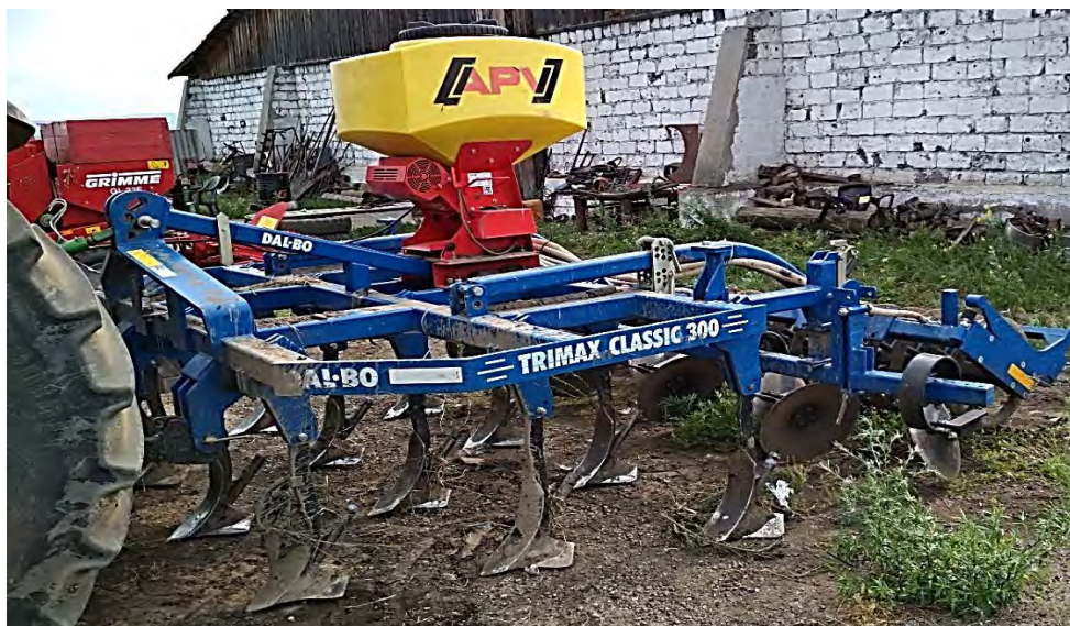
Рис. 2. Посевной модуль для разбросного посева на культиваторе-глубокорыхлителе
