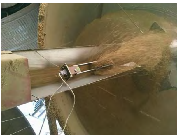
Рис. 2. Просыпной датчик влагомера Фауна-ПМДР4
