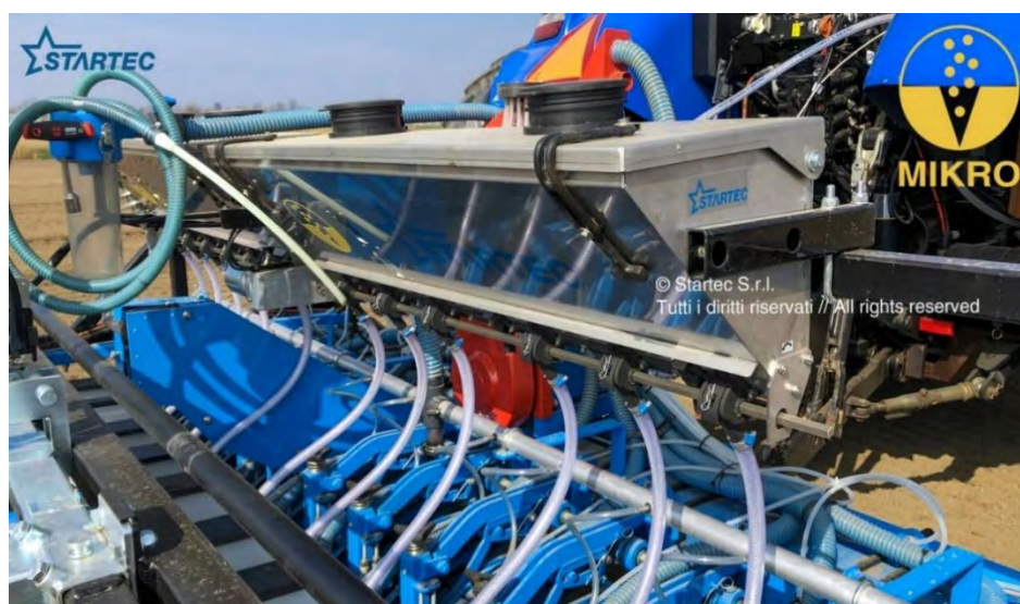
Рис. 1. Техническая система для внесения влагоудерживающих препаратов гравитационным методом Micro MI
