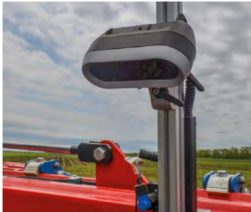
Рис. 3. Двухлинзовая оптическая камера [4]
