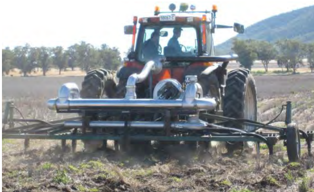
Рис. 1. Система подачи выхлопных газов в почву с теплообменником
