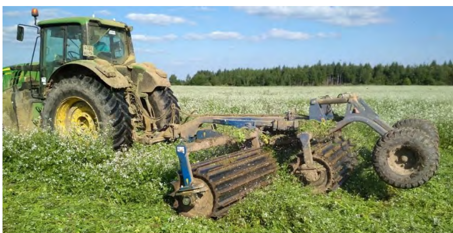
Рис. 3. Ножевой прикатывающий каток
