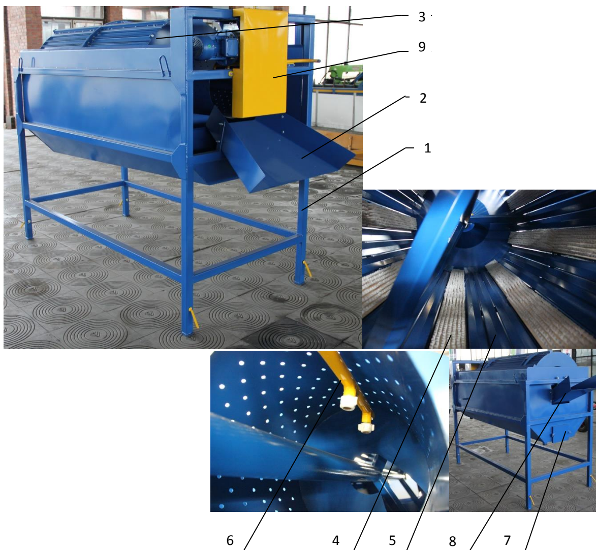
Рис. 1. Универсальная моечная машина барабанно-щеточного типа: 1 – рама; 2 – приемный лоток; 3 – барабан моечный; 4 – щеточные вставки; 5 – профильные планки; 6 – домывающее устройство; 7 – ванна, 8 – выгрузной лоток; 9 – привод
