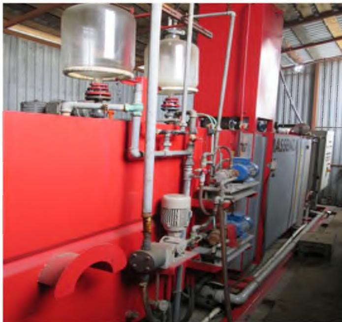
Рис. 2. Технологическая установка «MASSEHA» по производству битумной эмульсии
