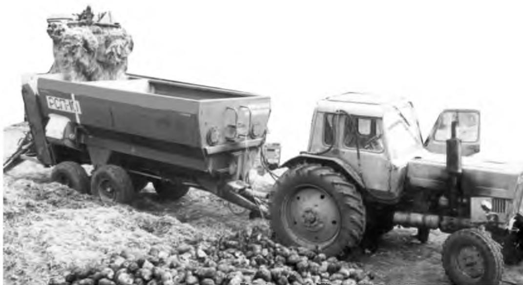
Рис. 4. Мобильный кормоприготовительный агрегат в работе
