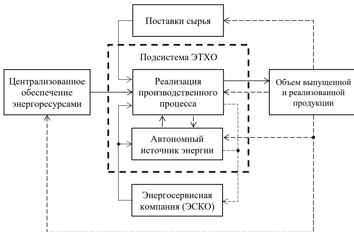
Рисунок 2. Обобщенная структурная схема функционирования подсистемы ЭТХО Figure 2. Generalized block diagram of the functioning of the ETE subsystem
