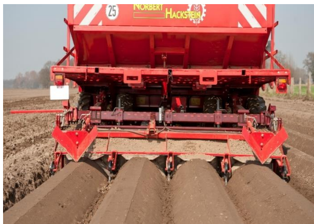
Рис. Картофелепосадочная машина, оснащенная гребнеобразующим устройством: а – гребнеобразующая плита; б – диаболические прутковые катки
