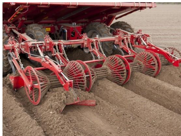
Рис. Картофелепосадочная машина, оснащенная гребнеобразующим устройством: а – гребнеобразующая плита; б – диаболические прутковые катки
