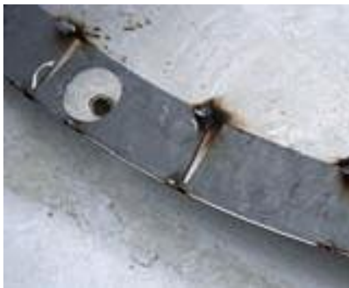
Рисунок 4. Прихватывание накладки к шнеку Figure 4. Attaching the lining to the auger
