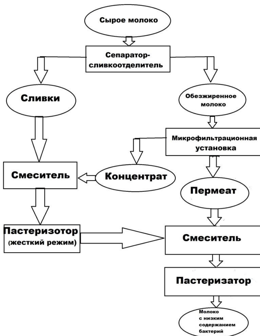
Рис. 2. Схема микрофльтрации цельного молока
