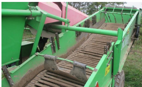
Рис. 2. Картофелеуборочный комбайн Volko Z-643: а) без устройств для разделения вороха; б) с устройствами для разделения вороха
