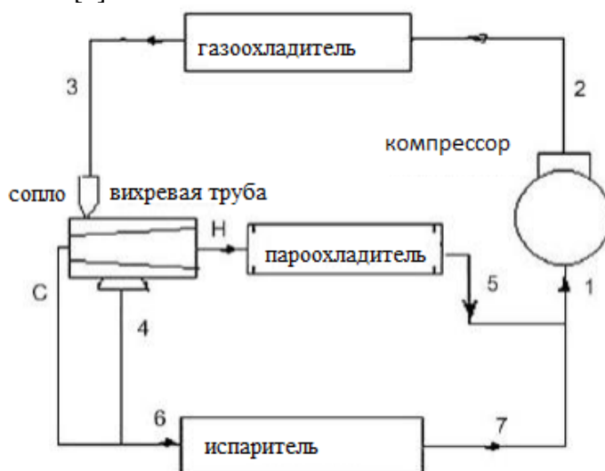
Рис1. Схема цикла расширения вихревой трубы для модели Маурера
