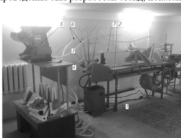
1 – Рамка, 2 – Транспортер, 3 – Электродвигатель, 4 – Редуктор, 5 – пневматическое высеивающее устройство PS 300 M1, 6 – Семяпроводы, 7 – Направляющая
