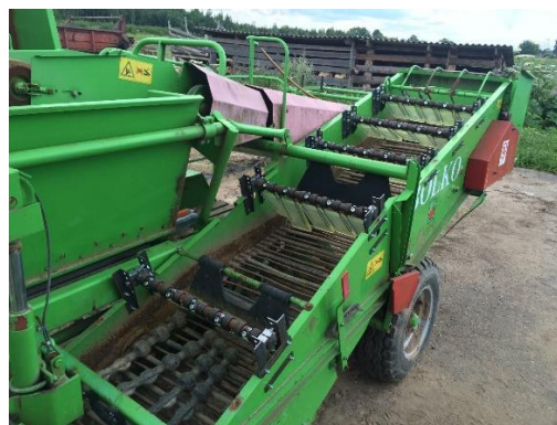
Рис. 2. Картофелеуборочный комбайн Volko Z-643: а) без устройств для разделения вороха; б) с устройствами для разделения вороха
