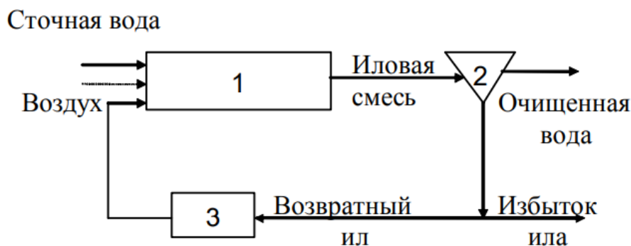
Рис. 2. Принципиальная схема установки традиционной биологической очистки с аэротенком [2]
