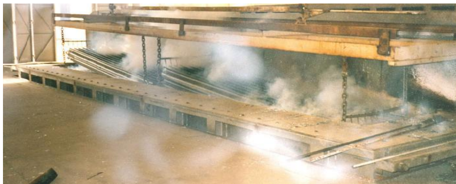
Рис. 2. Технология нанесения цинкового покрытия [2]
