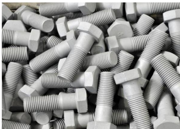
Рис. 5. Результат процесса термодиффузионной оцинковки [5]
