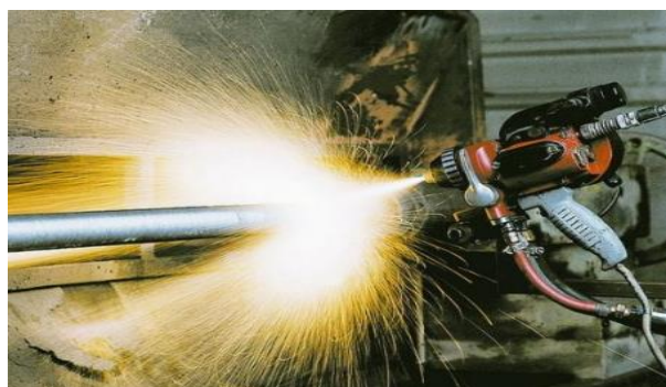
Рис. 7. Процесс газо-термической оцинковки [2]
