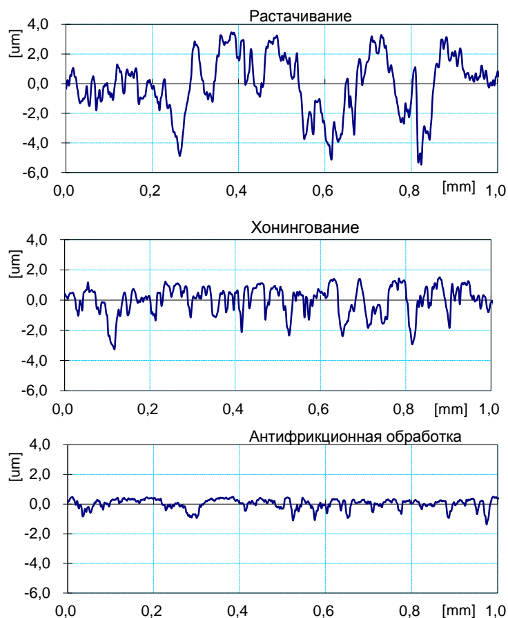
Рис.1. Профиль поверхности гильз после различных видов обработки
