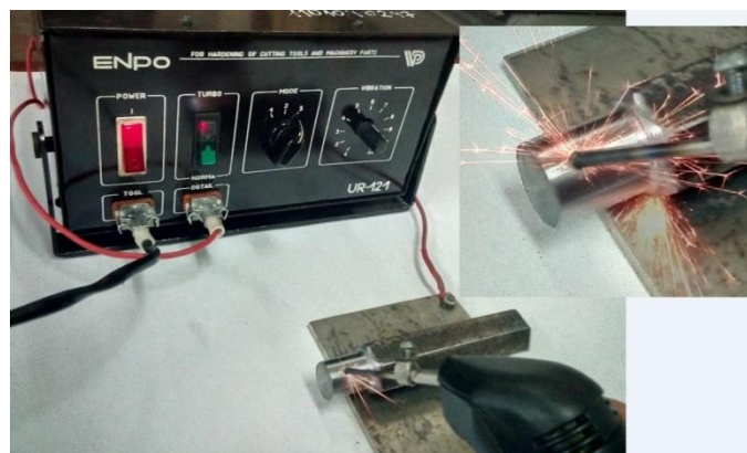
Рис. 3. Электроискровая обработка поверхности хвостовика Picture 3. Electrosarking of the Shank Surface
