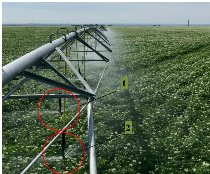
Рисунок. Фрагмент зон смачивания дождевателями широкозахватной круговой дождевальной машине фирмы T-L Irrigation company Figure. Fragment of sprinkler wetting zones of the T-L Irrigation company's wide-catchment circular sprinkler machine
