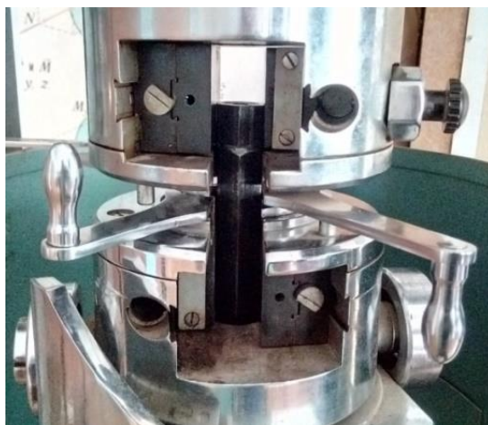
Рис. 4. Опытный образец перед сообщением крутящего момента Picture 4. Test Sample before Turning Torque Transmission
