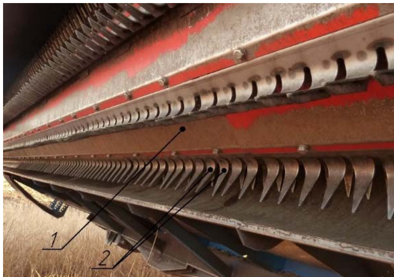
Рис. 1. Очесывающая жатка «ОЗОН»: 1 – ротор очесывающей жатки; 2 – съемная гребенка барабана очесывающего оборудования
