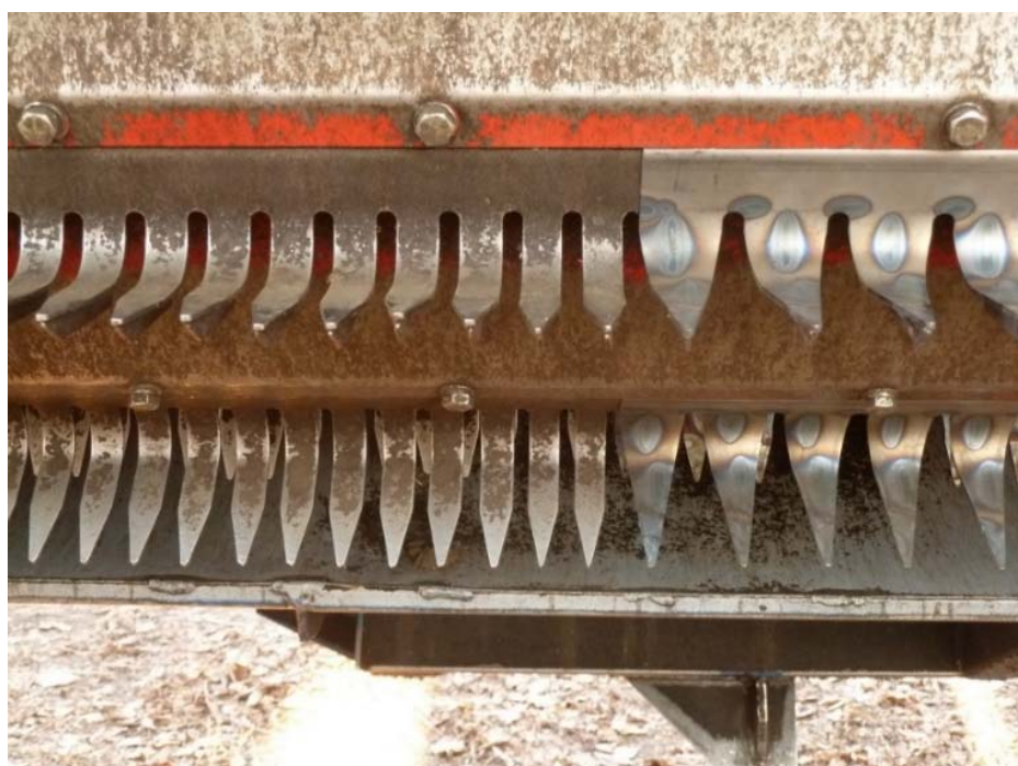
Рис. 5. Очесывающие гребенки жатки «ОЗОН»: слева – серийные; справа – экспериментальные рабочие органы
