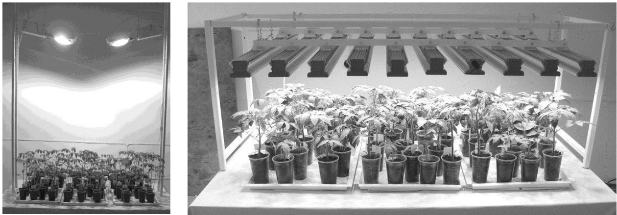
Рис. 4. Облучательные установки с лампами ДНаЗ (слева) и СД (справа)
