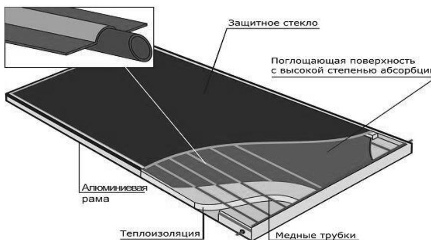
Рис. 3. Устройство плоского гелиоколлектора
