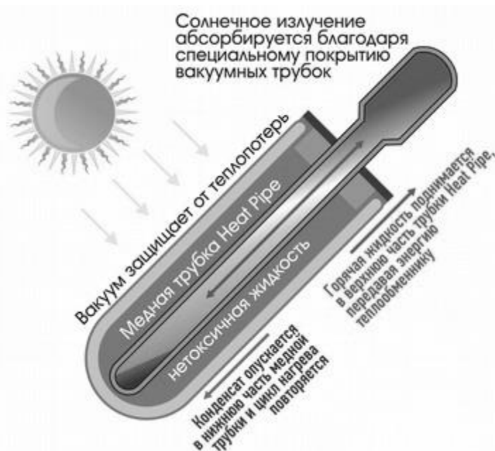
Рис. 4. Конструкция трубки вакуумного гелиоколлектора
