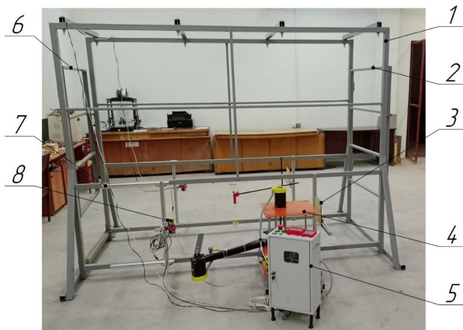
Рис. 4. Внешний вид усовершенствованной лабораторной установки: 1 – станок; 2 – входная дверца; 3 – экран калибровки; 4 – манипулятор; 5 – блок управления; 6 – выходная дверца; 7 – алюминиевый профиль для крепления камер; 8 – камера
