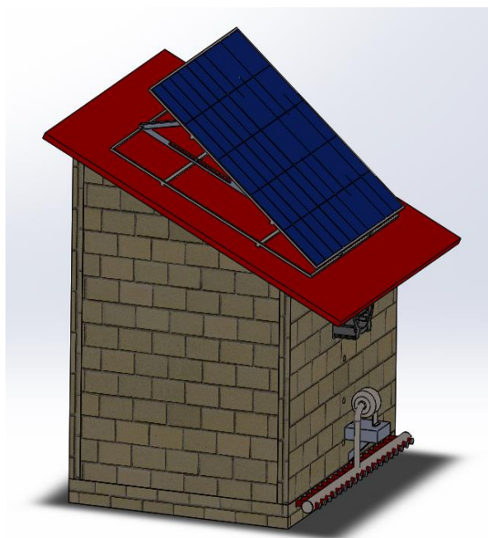
Рис. 2. Автономная биоферментационная установка камерного типа
