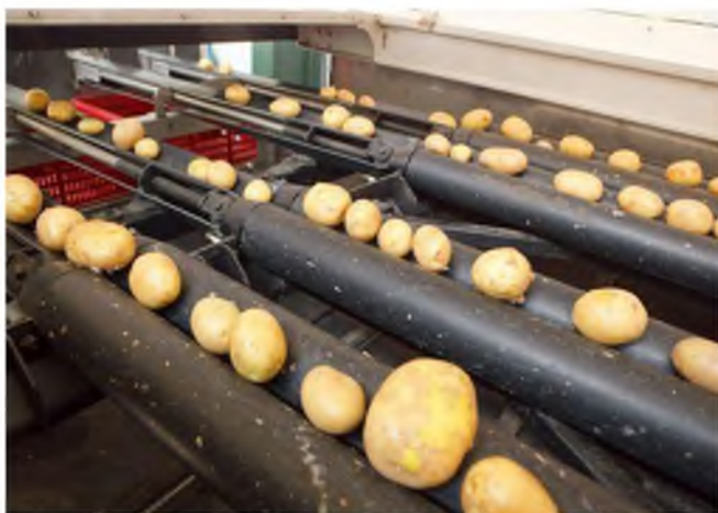
Рис. 2. Вибрирующие осевые ролики (Miedema Smart Grader)
