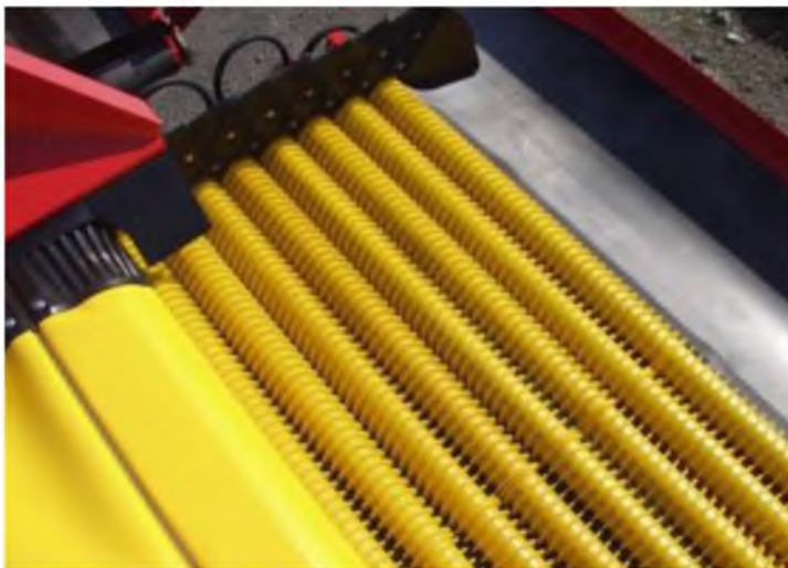
Рис. 1. Модуль отделения земли и предварительной сортировки продукта с мягкими полиуретановыми вальцами (Grimme SG)
