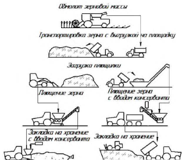
Рис. 1. Схема технологического процесса плющения и консервирования влажного фуражного зерна с биологическим консервантом
